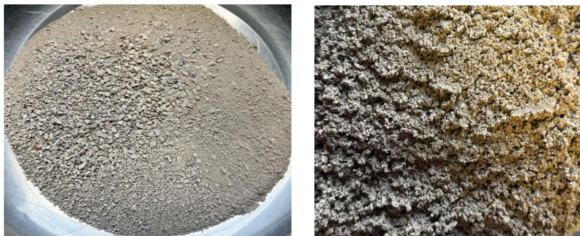
Рис. 1. Внешний вид песчаного грунта из отхода производства керамогранита
